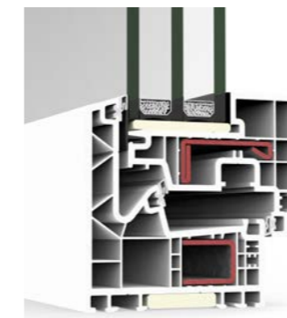
A 84 Hidden Sash Passivhaus
